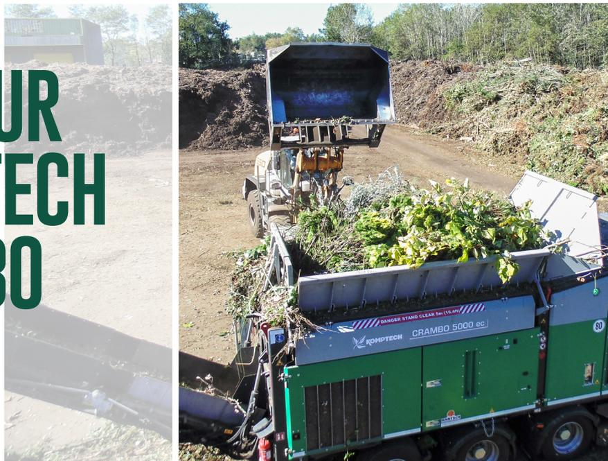
Le broyeur lent, **Crambo 5000**, est installé sur un châssis de remorque facilitant ses déplacements d'un chantier à l'autre. Celui-ci est équipé également d'une **avance automatique** lui permettant d'être autonome sur place.
